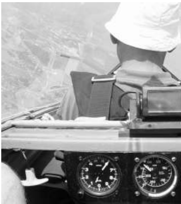
Op de meeste snelheidsmeters bevindt zich een geel driehoekje om de landingssnelheid bij windstil weer aan te geven
